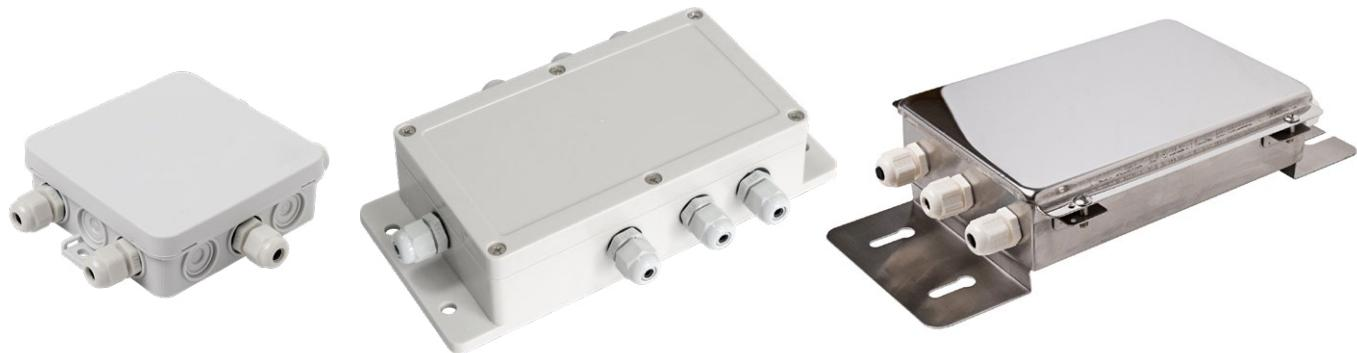
Клеммная коробка предназначена для параллельного подключения нескольких (до 4 шт.) тензометрических датчиков, работающих параллельно в составе весовых систем (весов), а также в составе устройств измерения статических или медленно изменяющихся сил, весовых дозаторов и других весовых систем.
