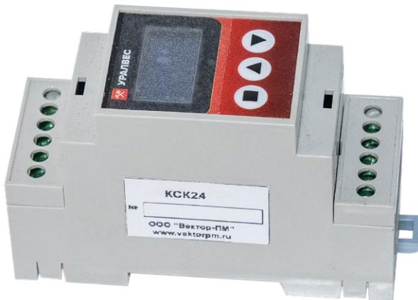
Прибор предназначен для измерения и преобразования сигналов весоизмерительных тензодатчиков в стандартный токовый сигнал 4-20 мА или сигнал напряжения 0-10В. Подключение тензодатчиков осуществляется по четырёхпроводной схеме.
